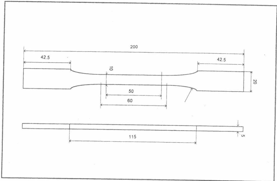
Fig. 1. Tensile Test Specimen
