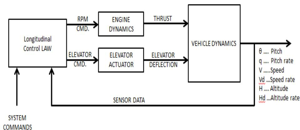
**Fig.9. Longitudinal Controller**
